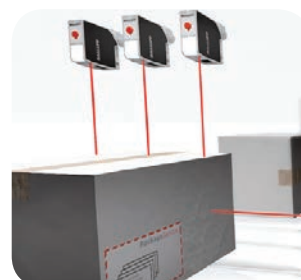
Optik mesafe sensörleri konveyör üzerindeki ürünlerin boyutlarını yada hatalarını sürekli olarak algılar.
