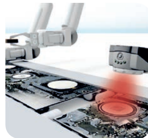
Görüntü işleyen kamera sensörleri pcb üzerindeki kodları okur ve denetler.
