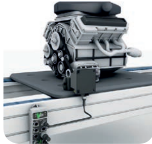
Motor montaj hatlarına yerleştirilebilen RFID, tüm üretim aşamalarının izlenebilirliğini sağlar.
