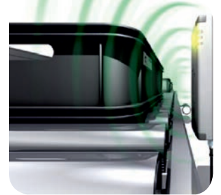
Lojistik sektöründe, taşıyıcı paletlerin üzerindeki RFID Tag'ler ile her palet doğru zamanda doğru yerde.
