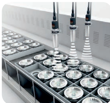
Kasa içindeki ürünlerin varlık yokluk kontrolü ultrasonik sensörler ile hatasız bir şekilde algılanır.
