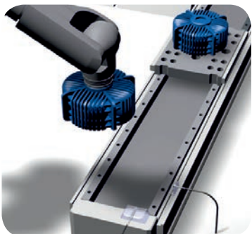
Konveyörlerde endüktif sensörler ile pozisyon kontrolü yapılıp.
