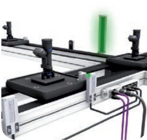
RFID, paletlerin doğru sıra ile üretim aşamasına geldiğini kontrol eder.
