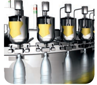
Lineer cetveler ile hızlı dolum makinelerinde seviye kontrolü yapılabilir.
