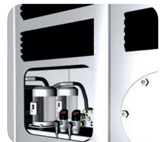
Rüzgar türbinlerinde, ana hidrolik güç ünitesi basınç sensörleri vasıtasıyla gözlenir.
